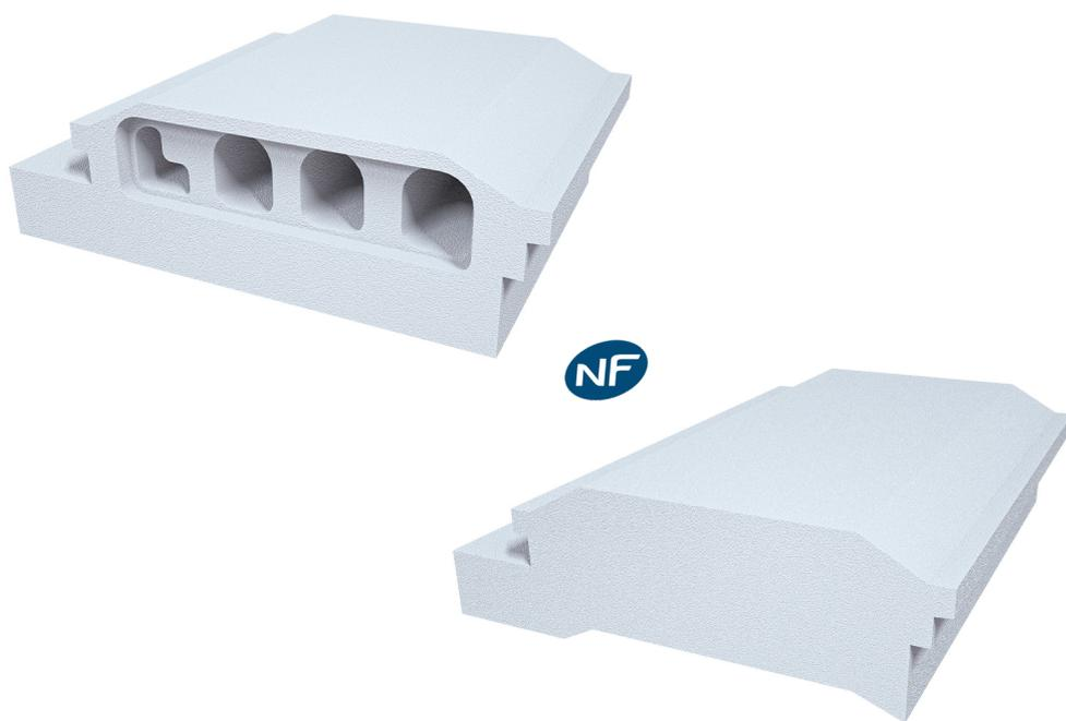
La taille standard des gammes d'entrevous EDIL-Voutain+ et EDIL-Moulé est dimensionnée par un entraxe de 600 mm sur une longueur de 600 mm (EDIL-Moulé) et 1260 mm (EDIL-Voutain+). Deux hauteurs coffrantes sont proposées en 120 mm et 150 mm. Tous les entrevous sont dotés d'une languette venant isoler la sous face des poutrelles, annihilant ainsi efficacement les ponts thermiques.
