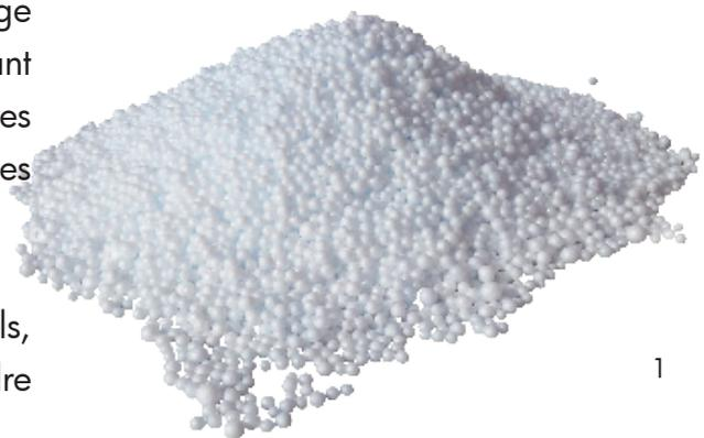
**Dès lors, les formules POLITERM® 900 et POLITERM® 1200, sont des mortiers et bétons légers dont les masses volumiques, variant entre 900 kg/m<sup>3</sup> et 1200 kg/m<sup>3</sup>, s'avèrent inférieures à celles d'un béton traditionnel. Les gains de poids respectifs de 65 % et de 50 %, permettent donc l'allègement des structures.**
