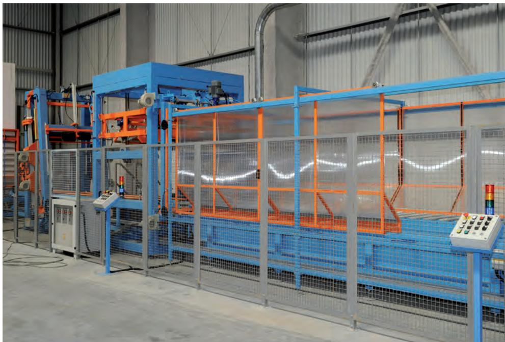
Une fois stabilisé, le bloc est emmené sur la ligne automatisée de découpe des plaques. Il est basculé à l'horizontal pour être coupé à dimension par des fils chauffants et vibrants ; les bords sont d'abord coupés pour constituer un bloc net, puis ce bloc est tranché dans son épaisseur puis dans sa longueur. La dimension standard est le 1200 x 600, le 1000 x 500 étant rare en France. Les plaques sont ensuite palettisées. Quant aux déchets, ils sont broyés et remis en silo pour être réutilisés.
