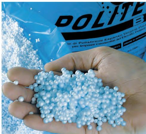
Pour l'adjuvantation, les billes neutres sont mélangées avec les adjuvants et conditionnées dans des sacs d'une contenance allant de 50 à 500 litres pour les plus importants, destinés notamment aux centrales à béton.
