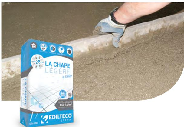
La Chape Légère by Edilteco® est une chape légère en sac prêt à l'emploi de 23 litres, allégée par des billes de polystyrène vierge expansées à granulométrie contrôlée et enrobées de l'adjuvant E.I.A. (diamètre 2 mm). La Chape Légère by Edilteco® est fibrée et possède de hautes propriétés mécaniques, elle est conforme à la norme NF EN 13813 et permet la pose directe du carrelage sans ragréage et après 48 heures seulement.
