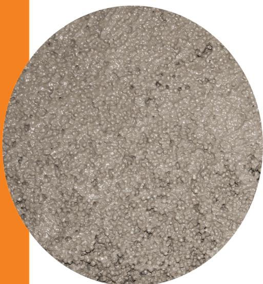
Les chapes POLYS BÉTO<sup>®</sup> Léger et POLYS BÉTO<sup>®</sup> Semi-Léger se mettent en œuvre très facilement. La consistance mousseuse permet une application simple et efficace, lors de la mise à niveau et la confection de supports de revêtements, prêts à recevoir directement un carrelage collé ou autre.
